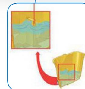
La revolucionaria forma de este cubo impide la formación de olas, con lo que se reducen en gran medida las salpicaduras en condiciones de uso normal.
